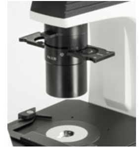
N. A. 0,3 Abbe Kondensor mit Phasenkontrastschieber
